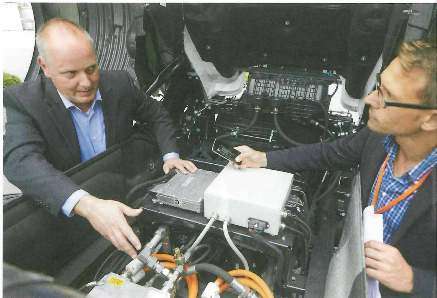
Sven Hönicke (links) erklärt ATZ-Redakteur Mathias Heerwagen, welche Technik IAV im Lkw verbaut hat – bis auf die Prototypen-Batterien sind die weiteren Bauteile im freien Handel erhältlich, etwa die Umrichter und Elektromotoren
